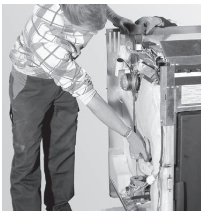
rys. 12 Miejsca chwytu - wylot rury podajnika ślimakowego i kanału spalinowego
