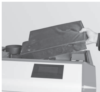
rys. 74 Zamontować izolację na pokrywie wymiennika ciepła
