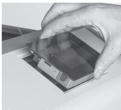
rys. 72 Włożyć InfoWIN Touch do panelu operatora
