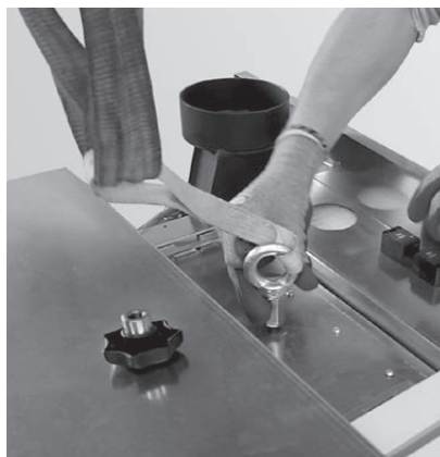
rys. 16 Zamontować śrubę z uchem (nie jest dostarczana w komplecie) dla haka żurawia
