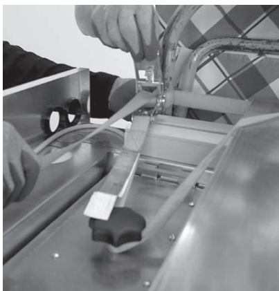
rys. 14 Przyczepić kocioł do dwukołowego wózka ręcznego za pomocą pasa transportowego
