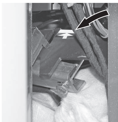
rys. 40 Dokręcić śrubę mocującą u góry do oporu (zgodnie z zaznaczeniem)
