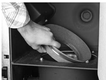
rys. 74 Wyjmij górną część konusa
