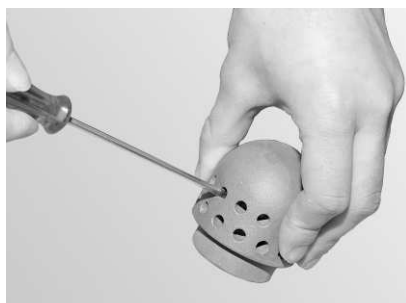
rys. 80 Wyczyść otwory powietrza pierwotnego
