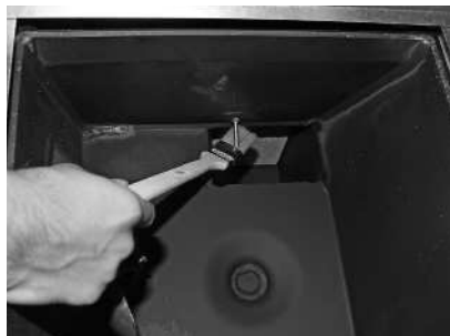
rys. 71 Wyczyść czujnik Thermocontrol
