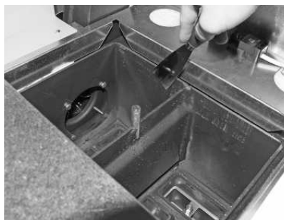
rys. 91 Wyczyścić wymiennik ciepła
