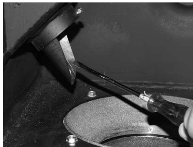
rys. 72 Wyczyść rynnę zsypaną pellet
