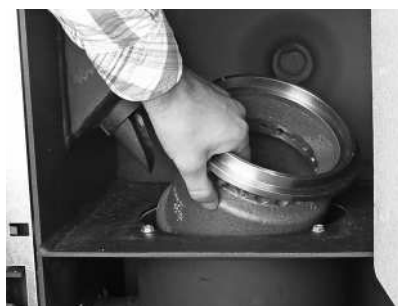
rys. 75 Wyjmij dolną część konusa
