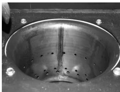
rys. 81 Wyczyść otwory powietrza wtórnego
