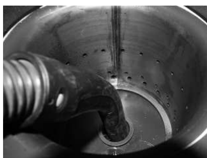
rys. 82 Odkurz rurkę powietrza pierwotnego w środku palnika
