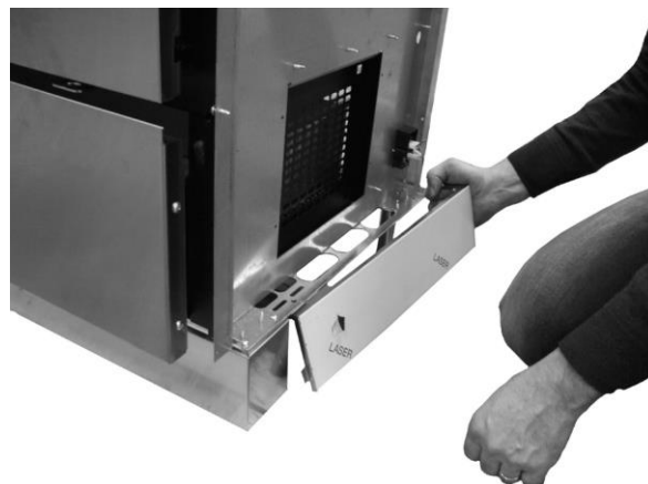
Rys. 36 - Demontaż listwy przypodłogowej
